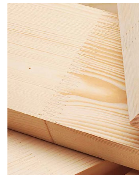
Keilzinkung mit Fichtenholz in der Detailaufnahme.
