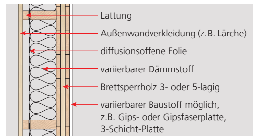
Beispiel Außenwand Holzmassivbau, hinterlüftet/belüftet, ohne Installationsebene, Außenschalung
