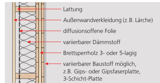
Beispiel Außenwand Holzmassivbau, hinterlüftet/belüftet, ohne Installationsebene, Außenschalung
