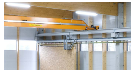
Beispiel: Integrierte Schienen für Portalkran (Option)
